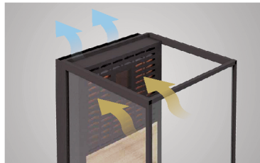
高レベルで吸気・脱臭・排気を行い、ブース内外の空気をクリーンに保ちます。
