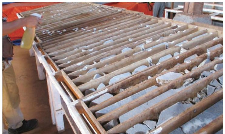
試錐により得られた岩石試料の観察(フィリピン共和国)
