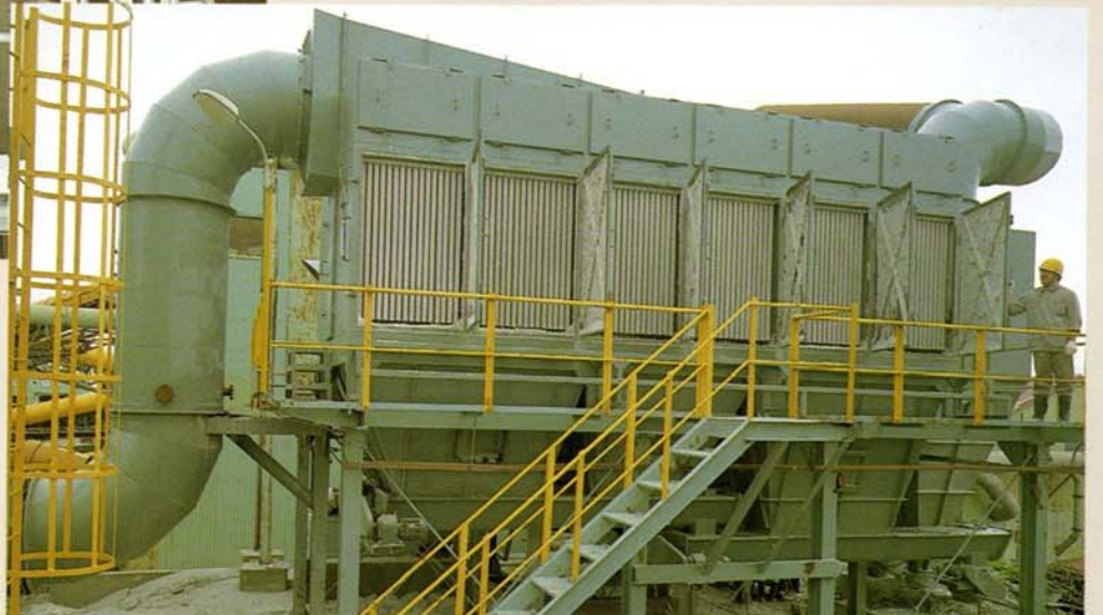
▲型式:HSL-1500-192/18-KH-F-SR(処理風量2000m 3 /min)
