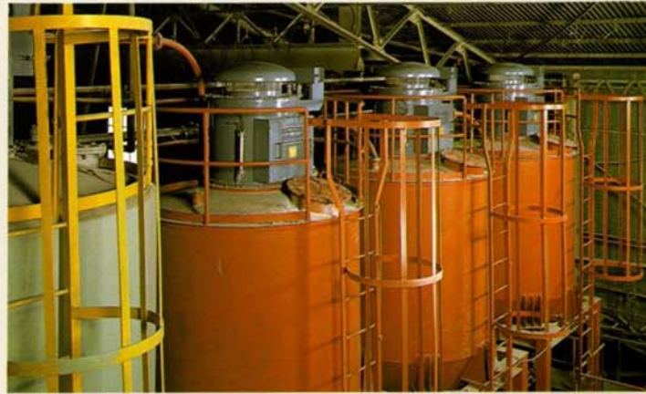
▲製品タンク脱気用 型式:HSL-450-8/8-KU
