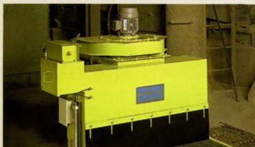
▲型式:ML-450-3/18-KH-F(処理風量10m 3 /min)
