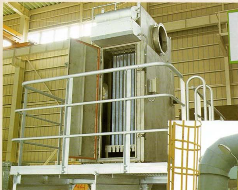
▲型式:HSL-1500-8/18-KH(処理風量80m 3 /min)
